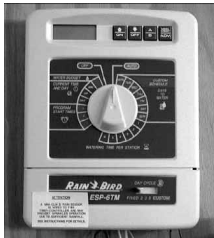
Slika 3.: Uredaj za uključivanje/isključivanja sustava za navodnjavanje prema definiranim terminima [3]
